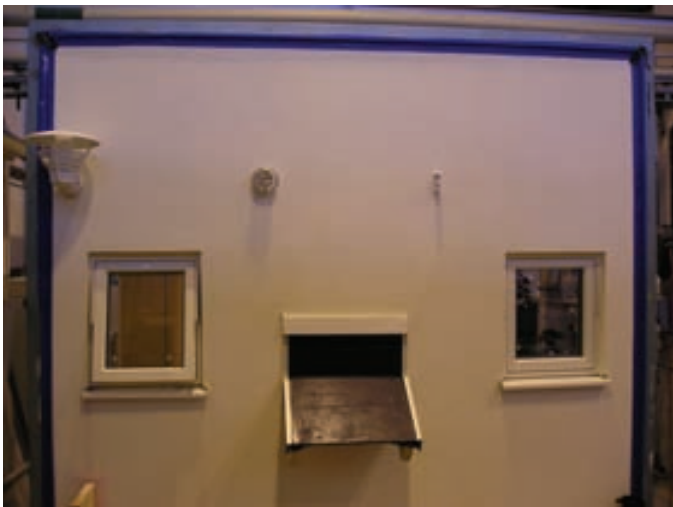
Figur 10.1 Provvägg 3*3 m för regntäthetsprovning med två fönster, ett skärmtak, en lampa, en ventil och en stupörsinfästning.
